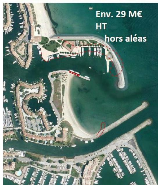
Par ailleurs, je rappelle à toutes fins utiles que l'aménagement de la digue Nord n'est pas dissociable de celui de la digue Sud puisqu'ils constituent les deux axes majeurs d'un projet global de réaménagement dont l'objectif est de lutter contre l'ensablement récurrent de l'avant-port et de la passe d'entrée.
